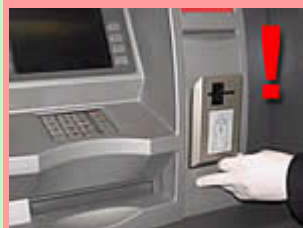
Okienko wrzutowe z założonym dodatkowym czytnikiem kart
